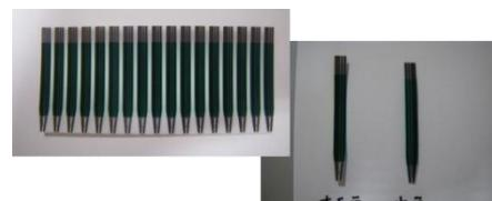
センサ部分はディスポーザブルの印刷電極(三極式)でエッペンチューブに差し込みやすく、メンブレン法でも使用しやすい形状とした。
